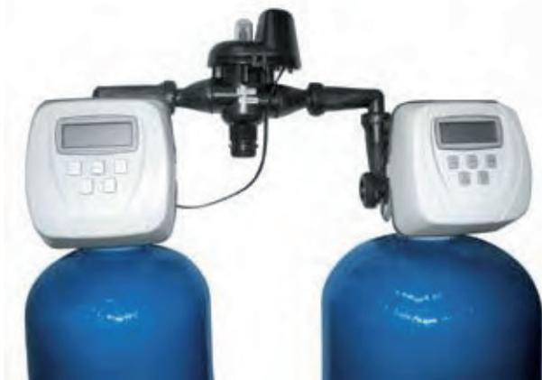
Gli Addolcitori AQUA della serie PROFESSIONAL mod. WLEV DUPLEX con timer elettronico, sono costituiti da 2 Colonne, con 2 Valvole, da una valvola motorizzata a 3 vie e da 2 Tini salamoia per dare maggiore autonomia tra una rigenerazione e l'altra, in quanto funzionano in alternanza erogando sempre acqua addolcita 24 ore su 24.
