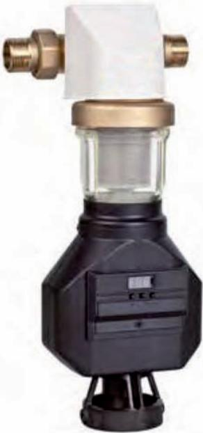
Il filtro dispone di un meccanismo a motore comandato con circuito a tempo per mezzo di una scheda elettronica. In base alle caratteristiche dell'acqua da filtrare, l'utente può programmare il controlavaggio in automatico con intervallo da 1 a 999 ore.
